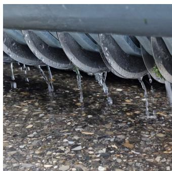
Der Fluid Feeder dient der Applikation diverser Flüssigkeiten direkt in den Wurzelhorizont über die bekannten Scheibenschare, vergleichbar einer Schlitzensaat. Aufgrund des engen Reihenabstandes können neben Mikroorganismen auch Flüssigdünger ausgebracht werden.
