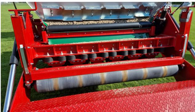
Die Mikroschlitze verbinden die Grasnarbe mit den zugewachsenen Sickerschlitzen und schaffen eine **schnelle Ableitung des anfallenden Niederschlages**. Die Verbesserung der Drainfähigkeit hält je nach Spielintensität ca. 5 Jahren an. Danach sollte der Zustand kontrolliert und die Massnahme gegebenenfalls wiederholt werden.
