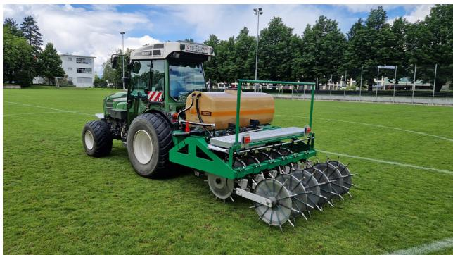
SWISS GREEN Fluid Injector est une machine permettant l'application de divers liquides directement dans le système racinaire des pelouses, via des pointes d'injection montées sur une roue à disques. La technique Cultan, bien connue dans l'agriculture, a été développée pour être utilisée sur les surfaces engazonnées. La profondeur d'application est de 6 à 8 cm, et l'espacement entre les points d'injection est de 12 à 15 cm.
