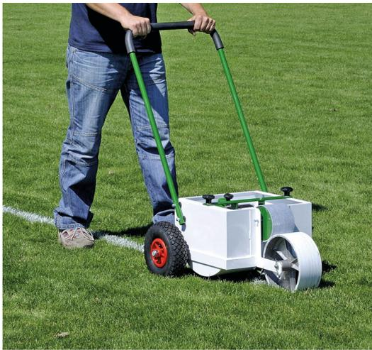
L'appareil de marquage LinoRoll est le modèle d'entrée de gamme économique pour le marquage professionnel par „pression“ avec de la peinture liquide des terrains de sport. Le LinoRoll est basé sur un entraînement purement mécanique. Il s'utilise idéalement en combinaison avec de la peinture de marquage éprouvée concentrée mais aussi avec de la peinture de marquage prête à l'emploi.
