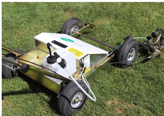
Das robuste wie bedienerfreundliche **Markierungsgerät LinoGold 2** sorgt mit der spritzfertigen Markierungsfarbe von **SWISS GREEN** für wirtschaftliches und effizientes markieren: Einfach den Kanister Markierfarbe auf dem Markierer aufsetzen, anschliessen und losfahren. Ganz ohne Wasser. Kein umständliches Mischen. Modernste Düsentekhnologie sorgt für ein optimales Markierergebnis. Selbstverständlich kann LinoGold 2 auch mit verdünntem Konzentrat markieren.
