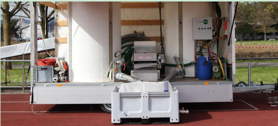
Das abgesaugte Waschwasser wird in eine mobile Reinigungsanlage gepumpt. In einem Reaktor werden Wasser und Schlamm getrennt. Dieses Verfahren ist einzigartig und ist nur durch ein speziell entwickeltes Reaktionsmittel möglich.
