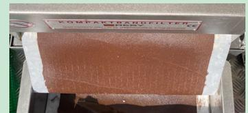
Der entwässerte Schlamm wird gesammelt und fachgerecht entsorgt.
